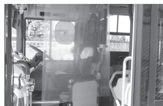
スクールバス ：運転席と乗客席との間をビニールシートで仕切り、飛沫感染への防止をしています。
